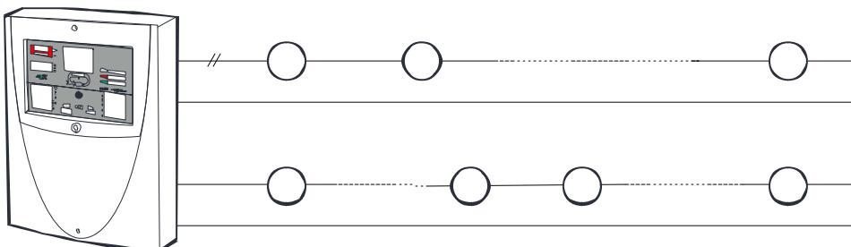
В каждом шлейфе в произвольном порядке можно установить максимум 159 извещателей и 159 модулей ввода-вывода.
