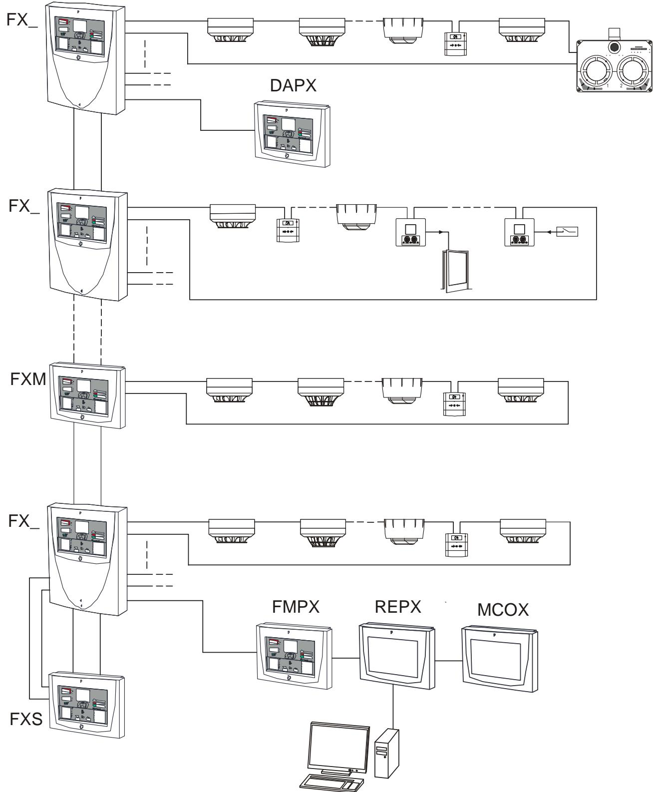
**Внимание!** При использовании связей по Инфо-протоколу максимальная адресная емкость в шлейфе составляет 214 устройств: нижний адресный диапазон 1...159 + верхний адресный диапазон 201...255.
