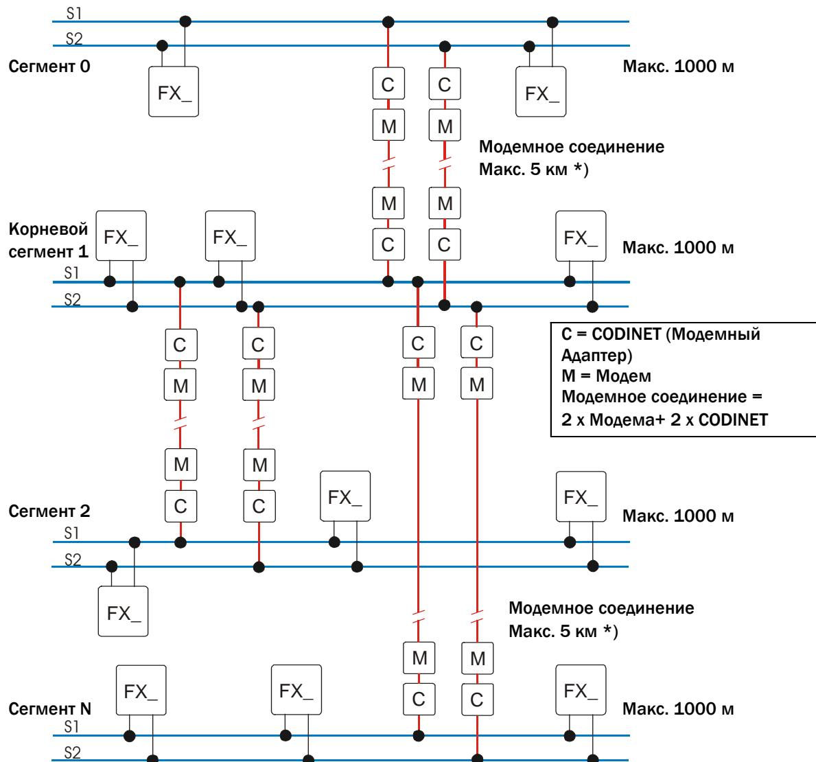
**Примечание!** Максимальное число модемных соединений между двумя панелями FX\_Net/RU - 2.
