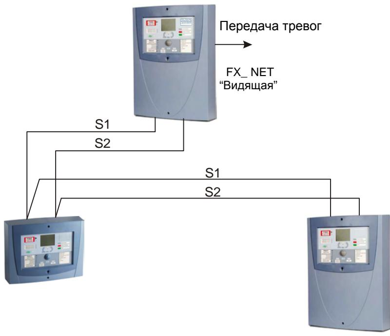
System 1 (S1) и System 2 (S2) = линия последовательной связи
