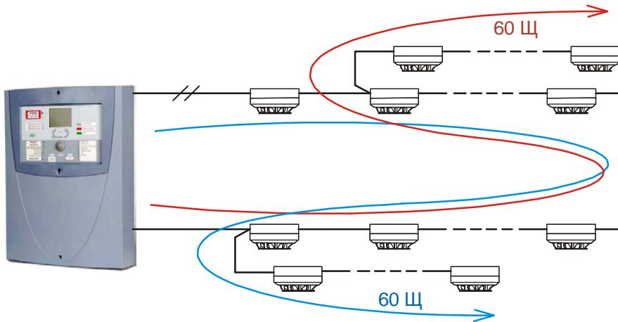
**Внимание!** При использовании связей по Инфо-протоколу максимальная адресная емкость в шлейфе составляет 214 устройств: нижний адресный диапазон 1...159 + верхний адресный диапазон 201...255.
